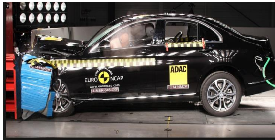
Рис. 1. Автомобіль зі спеціальними позначеннями для краш-тесту
